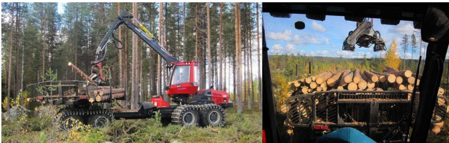
Figura 12: Protótipo de um *harwarder* da Komatsu.
