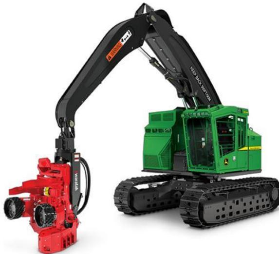
Figura 6: *Harvester* John Deere 853 MH com rodados de esteira.
