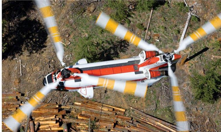
Figura 26: Extração com helicóptero ou heli-logging,BoingVertol 107.
