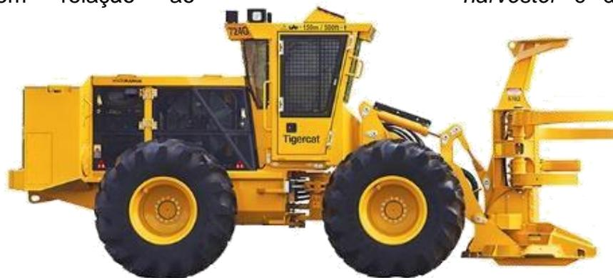
Figura 9: *Feller-buncher* Tigercat 724G com rodados de pneus.
