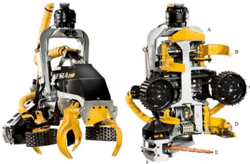
Figura 8: Cabeçotes Kesla 25RH, A: faca vertical, B: facas frontais, C: rolos de alimentação, D: facas traseiras, E: sabre de corte, F: caixa de proteção do sabre
