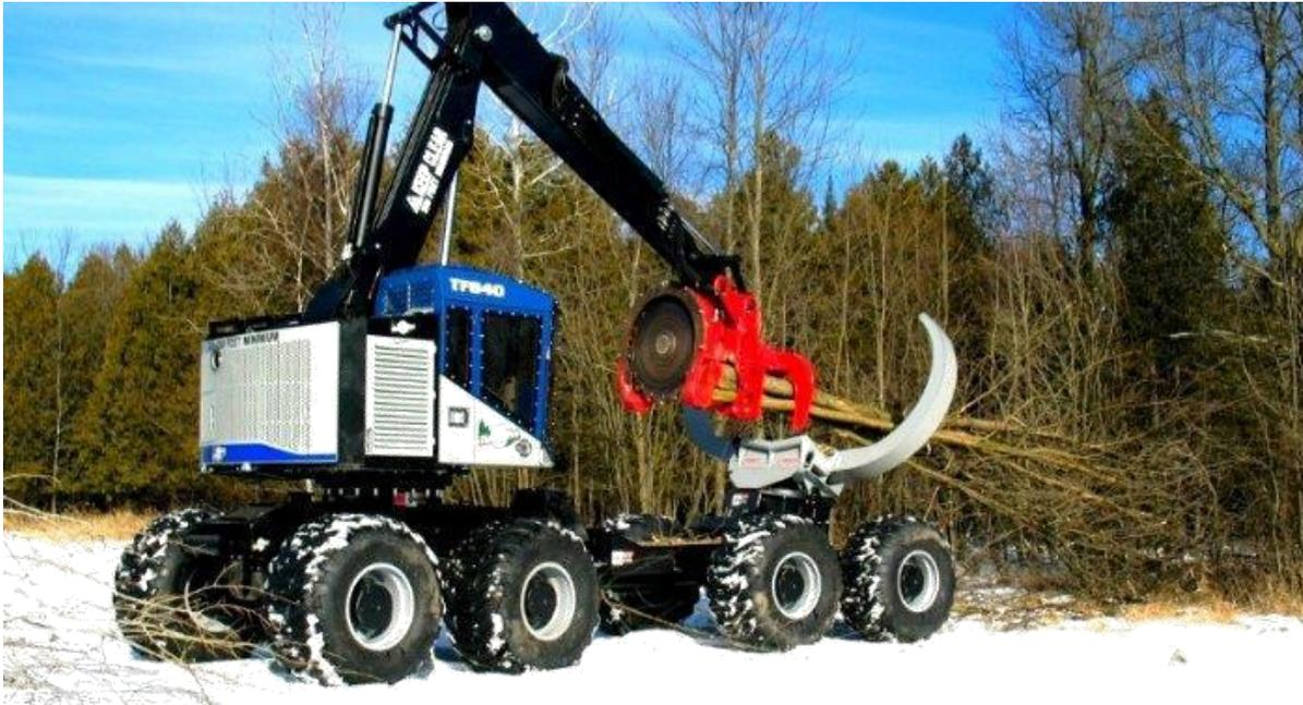
Figura 13: *Feller-skidder* com um implemento de garra invertida, semelhante a um *clambunskidder*.
