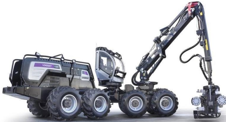
Figura 7: *HarvesterLogset 12H GTE Hybrid* com motor híbrido de 510 cv.
