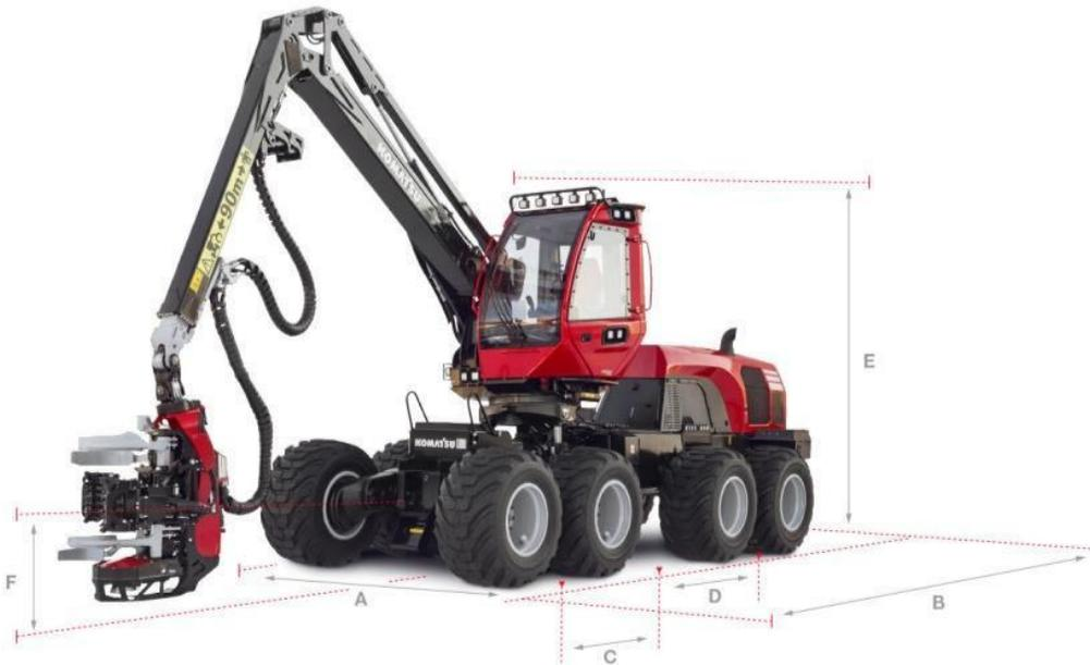
Figura 5: *Harvester* Komatsu 931XC com rodados de pneus 8x8.
