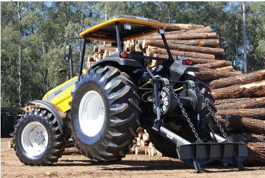
Figura 31: Trator agrícola com guincho caçador TMO 33 toneladas.
