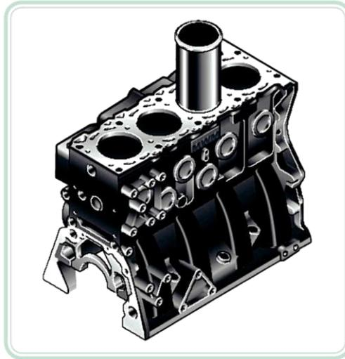
Figura 2.5: Bloco do motor com detalhe do encamisamento
