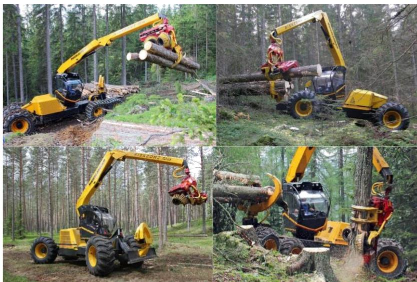
Figura 14: *Highlander*, máquina que reúne em um equipamento com rodados de pneus ou semi-esteiras características de um *harvester* com um *clambunkskidder*
