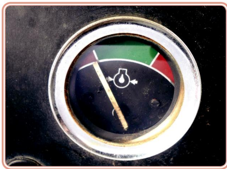
Figura 3.6: Marcador da pressão do óleo do motor do trator
