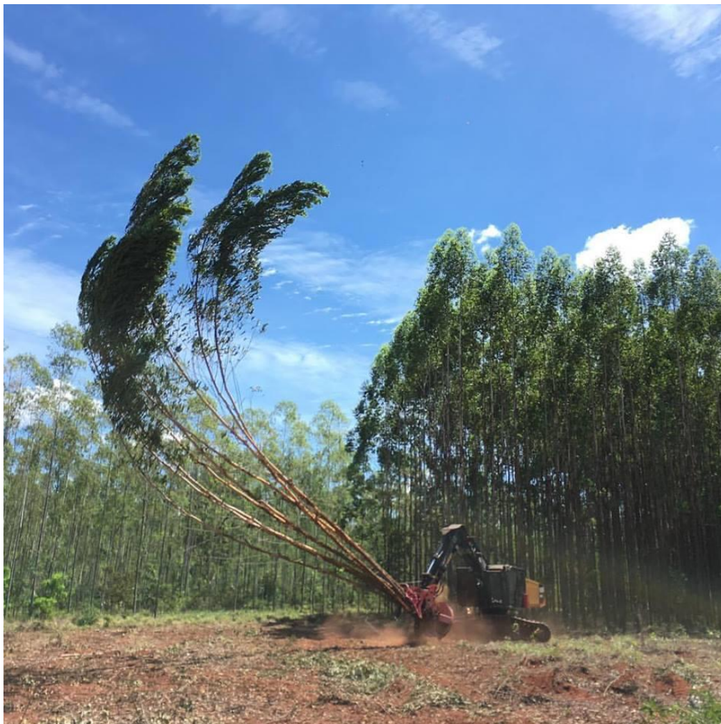
Figura 10: Feller-buncher com máquina base de esteira realizando a derrubada de um feixe de árvores.
