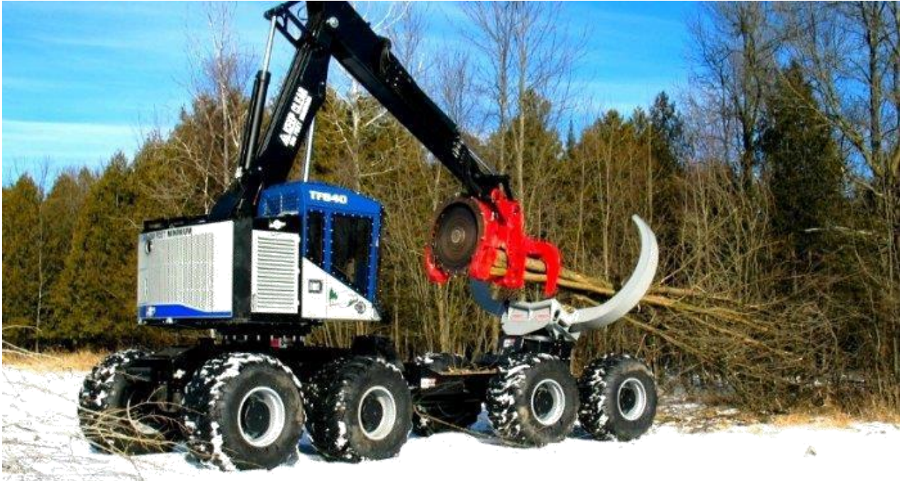
Figura 13: Feller-skidder com um implemento de garra invertida, semelhante a um clambunskidder .
