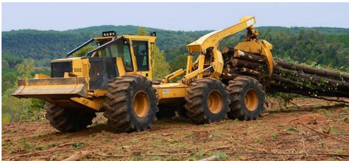
Figura18: GrappleSkidder Tigercat 635 E.
