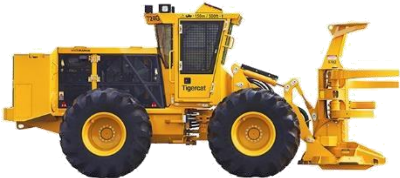
Figura 9: Feller-buncher Tigercat 724G com rodados de pneus.
