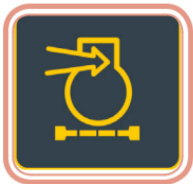
Figura 3.10: Marcador de restrição do filtro de ar
