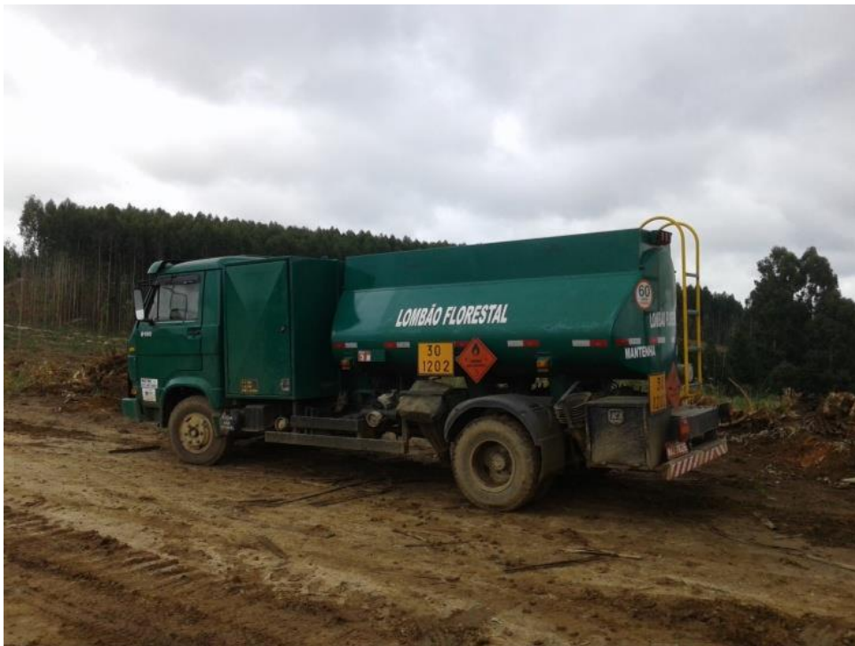
Figura 39: Caminhão comboio utilizado para o abastecimento das máquinas de colheita florestal.
