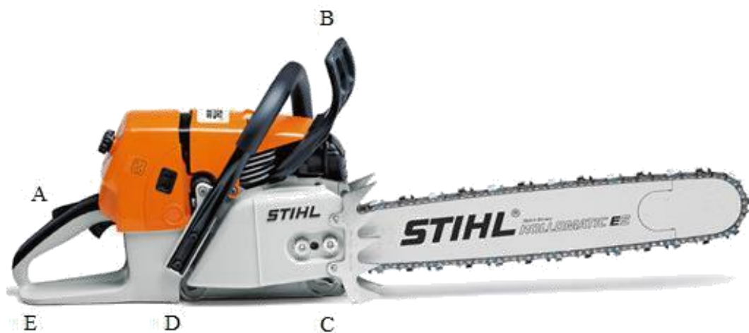
Figura 4: Dispositivos de segurança de uma motosserra - A: trava de segurança do acelerador; B: freio de corrente e proteção para mão; C: pino-pegacorrente; D: amortecedor; E: proteção para mão direita.
