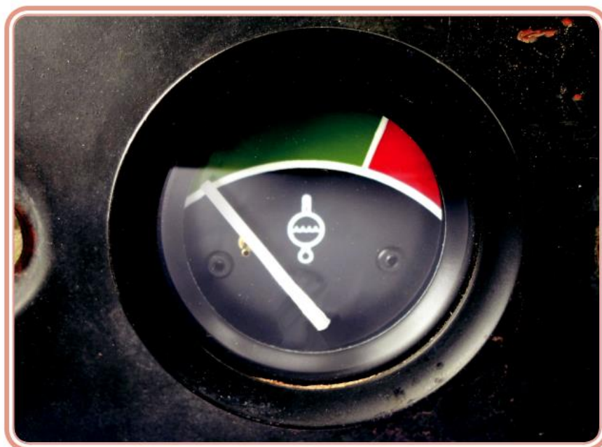
Figura 3.3: Marcador de temperatura da água do sistema de arrefecimento
