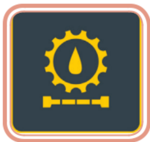
Figura 3.9: Marcador de alerta da pressão do óleo da caixa de câmbio
