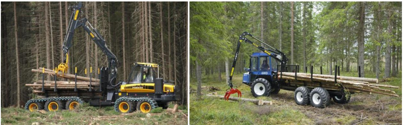
Figura 16: Forwarder Ponsse 10W com tração 10x10.
