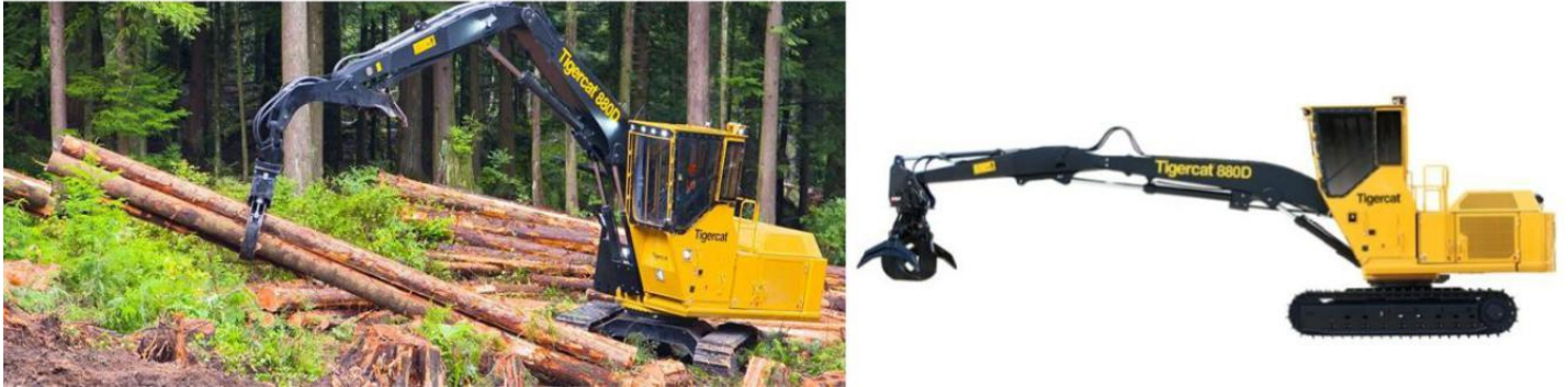
Figura 28: Shovel-logger , máquina com rodados de esteiras e implemento específico para movimentação de árvores.
