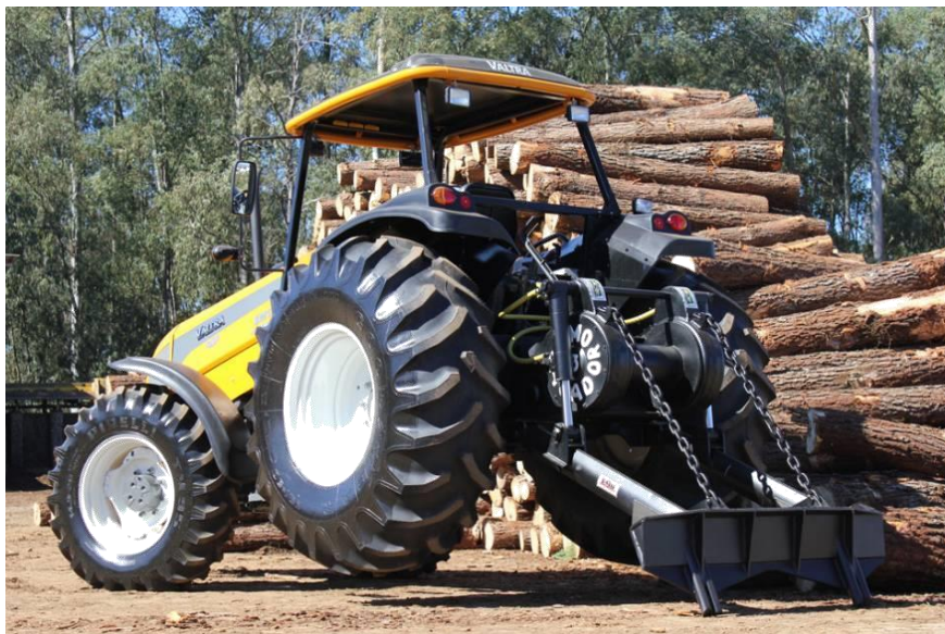
Figura 31: Trator agrícola com guincho caçador TMO 33 toneladas.
