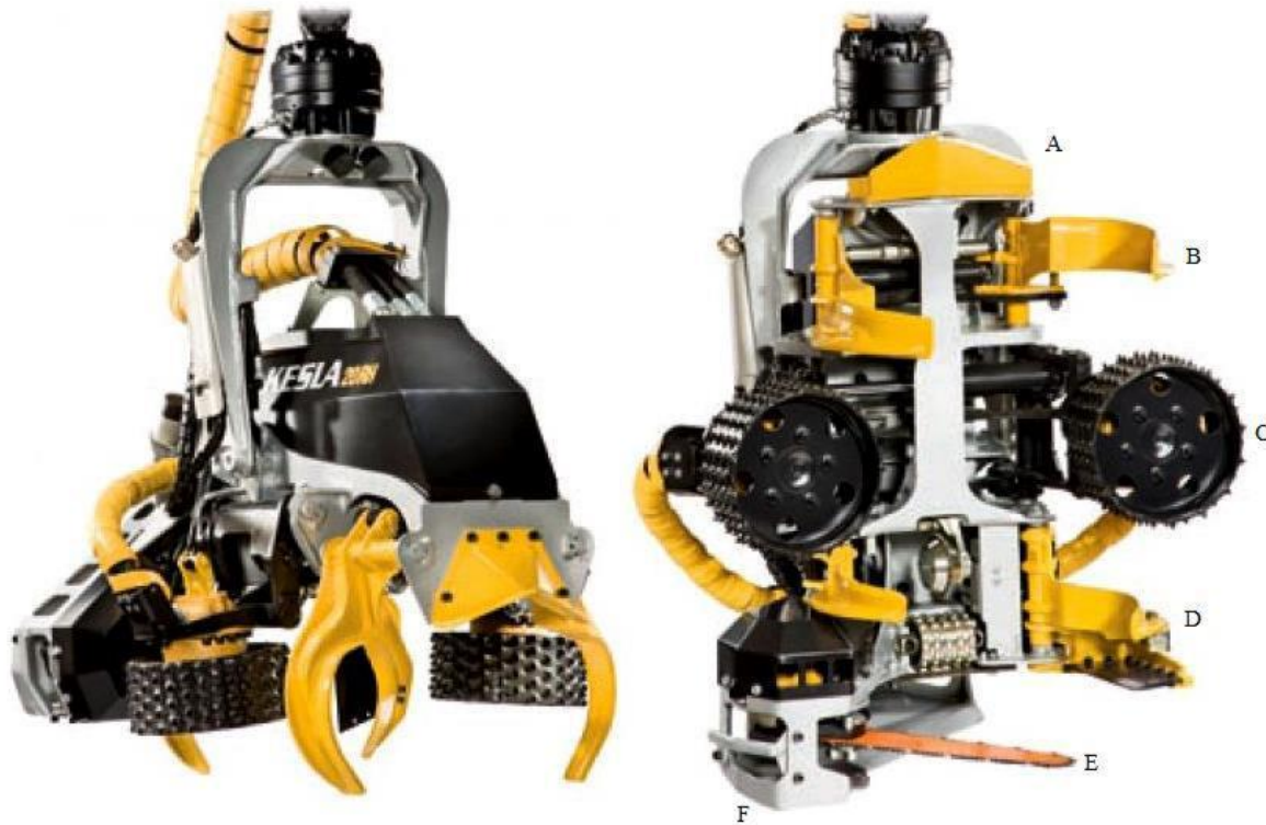
Figura 8: Cabeçotes Kesla 25RH, A: faca vertical, B: facas frontais, C: rolos de alimentação, D: facas traseiras, E: sabre de corte, F: caixa de proteção do sabre
