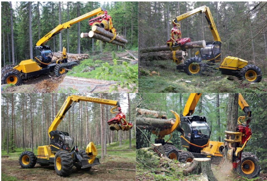
Figura 14: Highlander , máquina que reúne em um equipamento com rodados de pneus ou semi-esteiras características de um harvester com um clambunskidder
