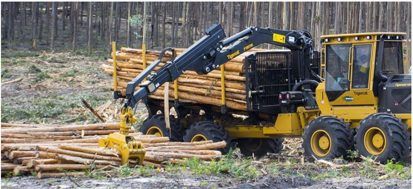
Figura 15: Forwarder Tigercat 1085C com capacidade de 25 toneladas.
